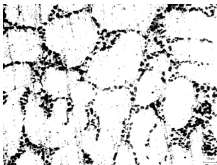
Рис. 6. Мікроструктура після гомогенізації при температурі 535 °С протягом 8 годин і загартування на повітрі:
